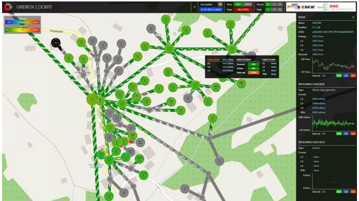
Bild 2: Das GridBox Cockpit visualisiert das System im Live-Betrieb und erlaubt den Zugriff auf aktuelle und archivierte Messwerte. Ebenso lässt sich die vom State Estimator errechnete Gesamtsystemsicht darstellen.
